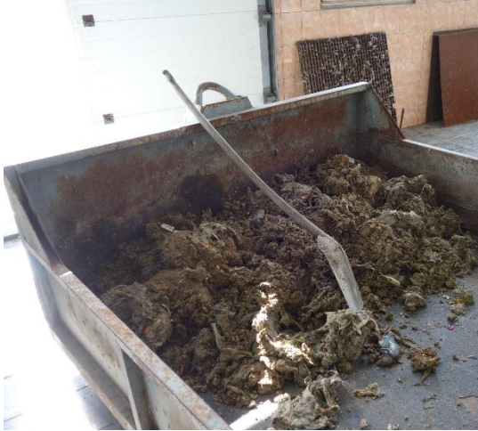
Odpad zachycený v budově hrubého předčištění.
